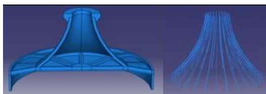
图 1 复合筒型基础实体及钢绞线
